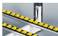
8 Longeron porteur Il supporte les rails à galets et assure leur planéité.
