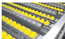
5 Rail à galets Se positionne sur les longerons au pas de 16,5 mm. Galets Ø 28 au pas de 33 mm.
