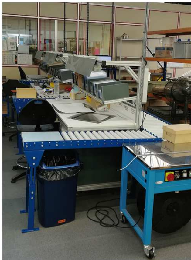
Les éléments modulaires de convoyeurs à rouleaux libres permettent de réaliser des lignes de manutention à la demande.
