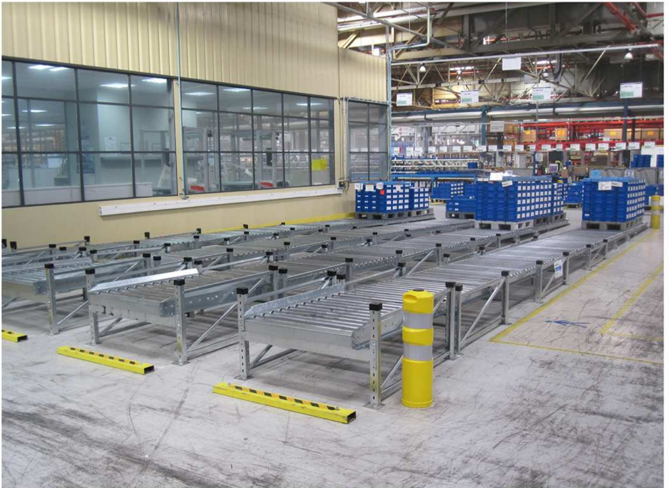
Lignes de dynamique au sol pour accumulation de palettes.
