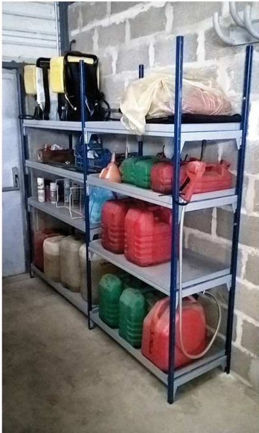
Rayonnage avec bac de rétention posé sur étagère.
