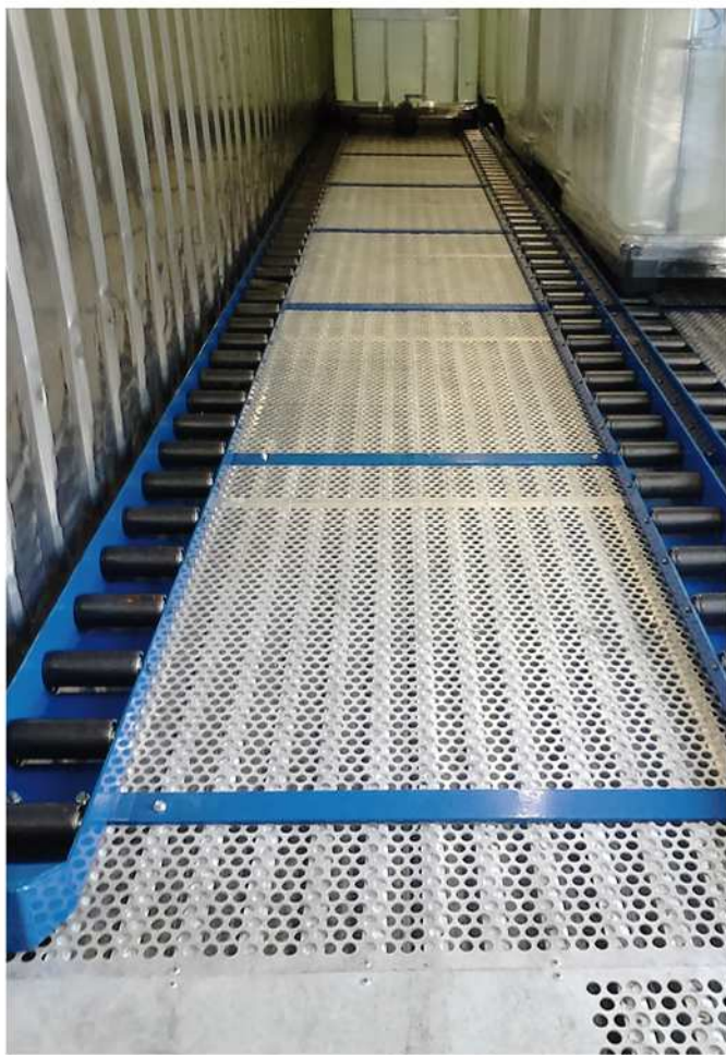
Rails au sol dans un conteneur.
