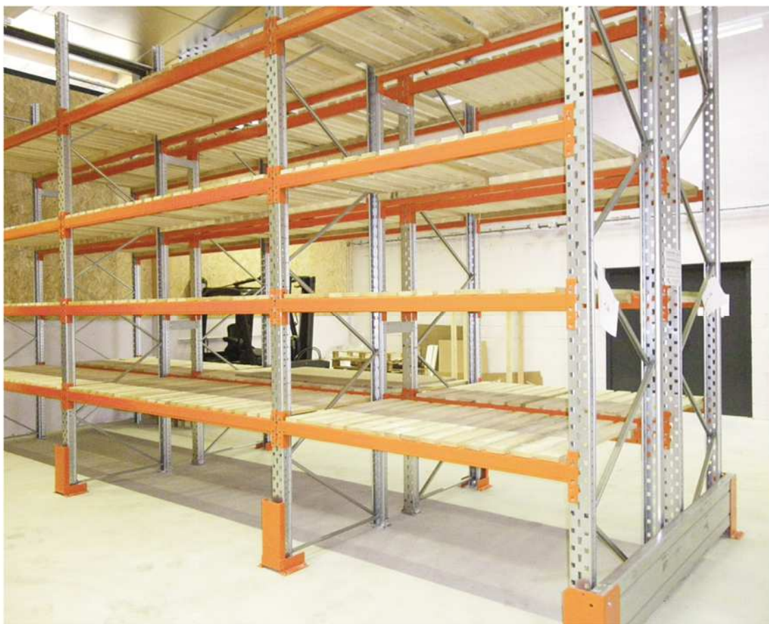
Rayonnage à palettes équipé de platelages sapin ajouré, protections de montants d'échelles et protections de bout de rangée.
