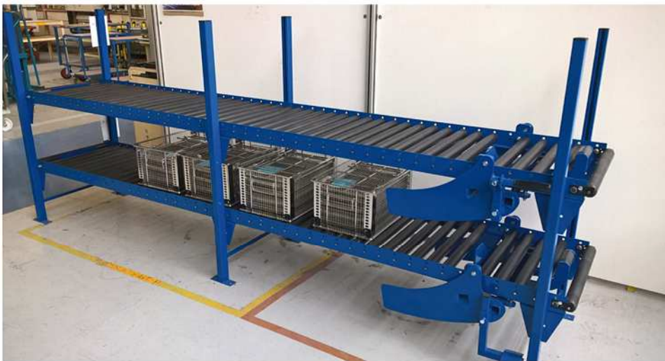
Convoyeur double niveau avec butées escamotables.
