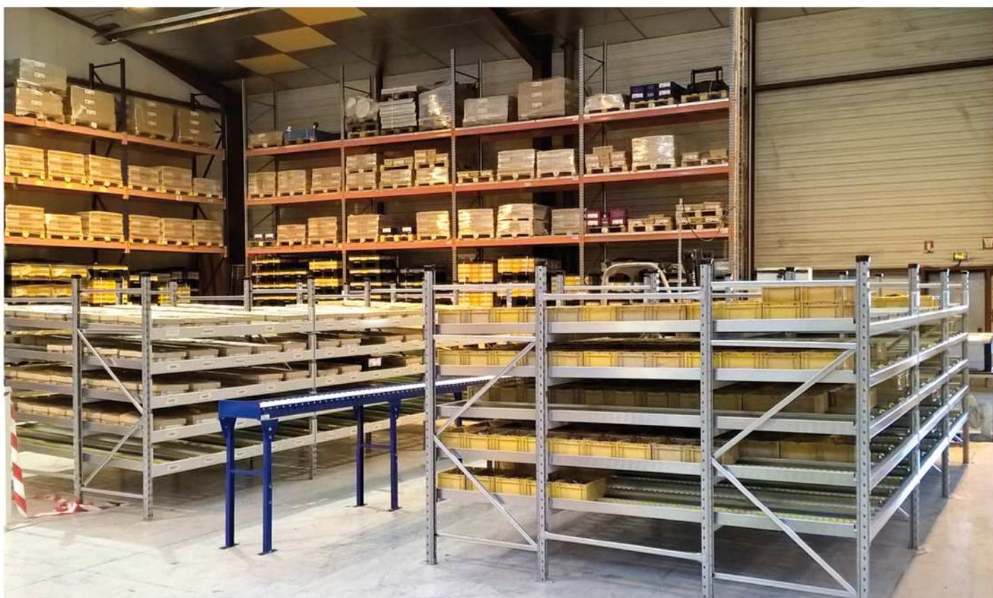
Le stockage dynamique permet de respecter le FIFO des bacs et des cartons.
