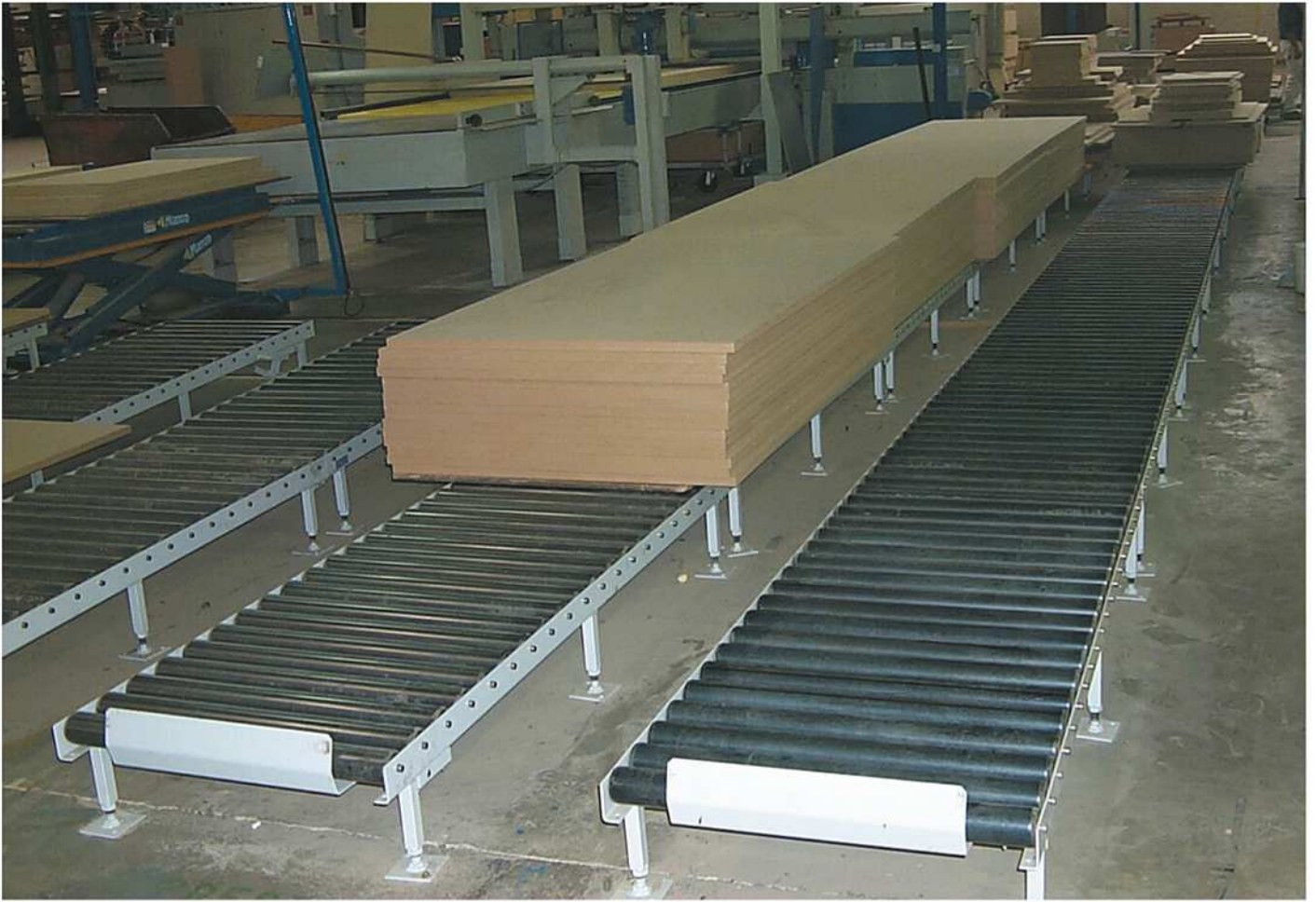
Lignes de convoyeur pour la manutention de panneaux agglomérés.
