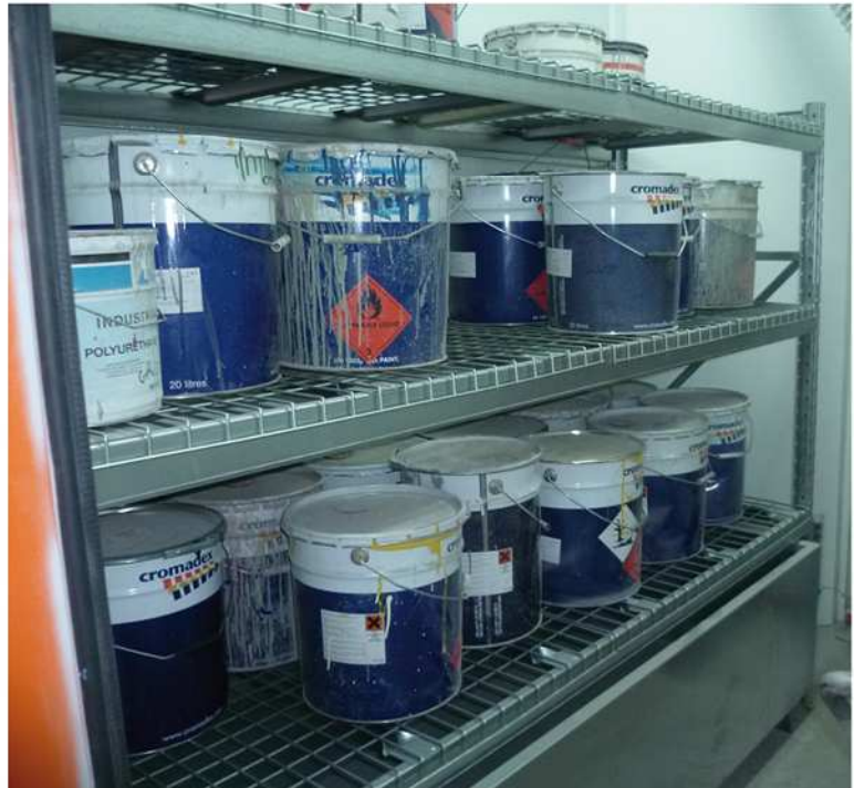
Rayonnage mi-lourd avec étagères en caillebotis et bac de rétention.
