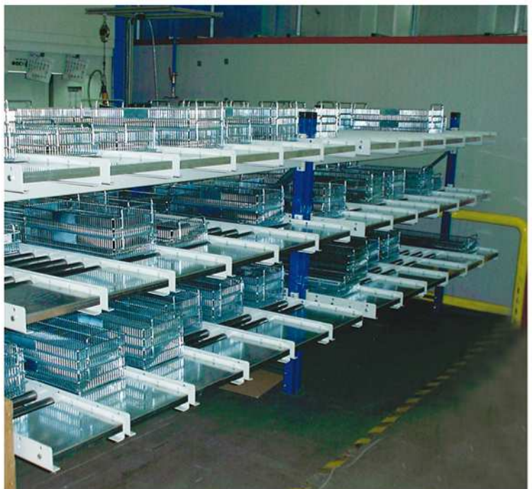
Stockage dynamique avec convoyeurs et tablettes présentoirs.
