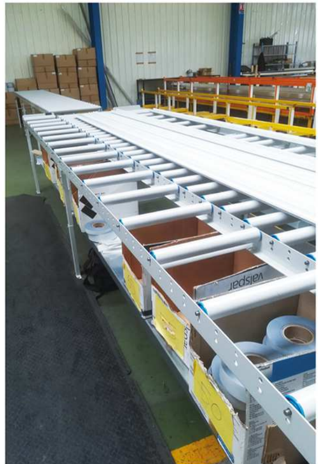
Ligne de convoyeurs avec étagères inférieures.
