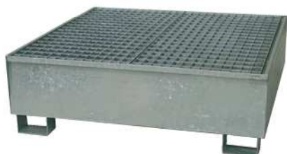
Bac 4 fûts. Rétention 440 l. L.1225 x P.1225 x H. 300 mm + pied 100 mm Réf. 60105
