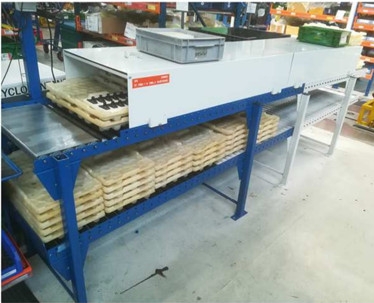
Convoyeur à rouleaux double niveaux avec tablette de dépose à l'entrée et carter de protection amovible.
