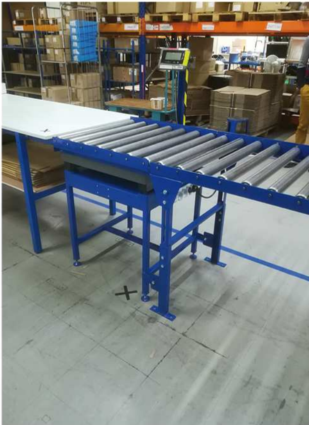
Ligne de convoyeur avec balance intégrée.
