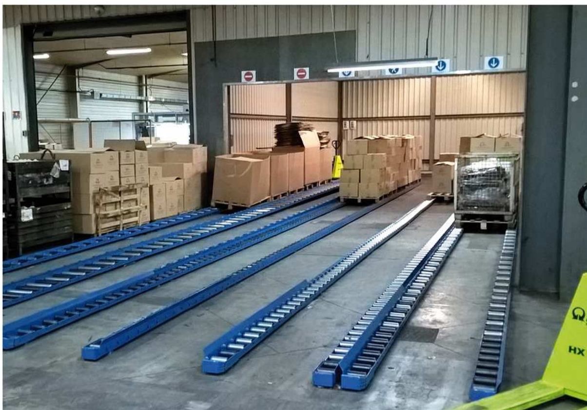
Rails à rouleaux au sol pour palettes lourdes adapté pour différentes longueurs de palettes.
