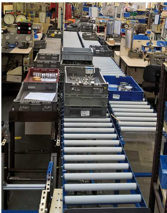
Lignes de convoyeurs avec poste de travail.
