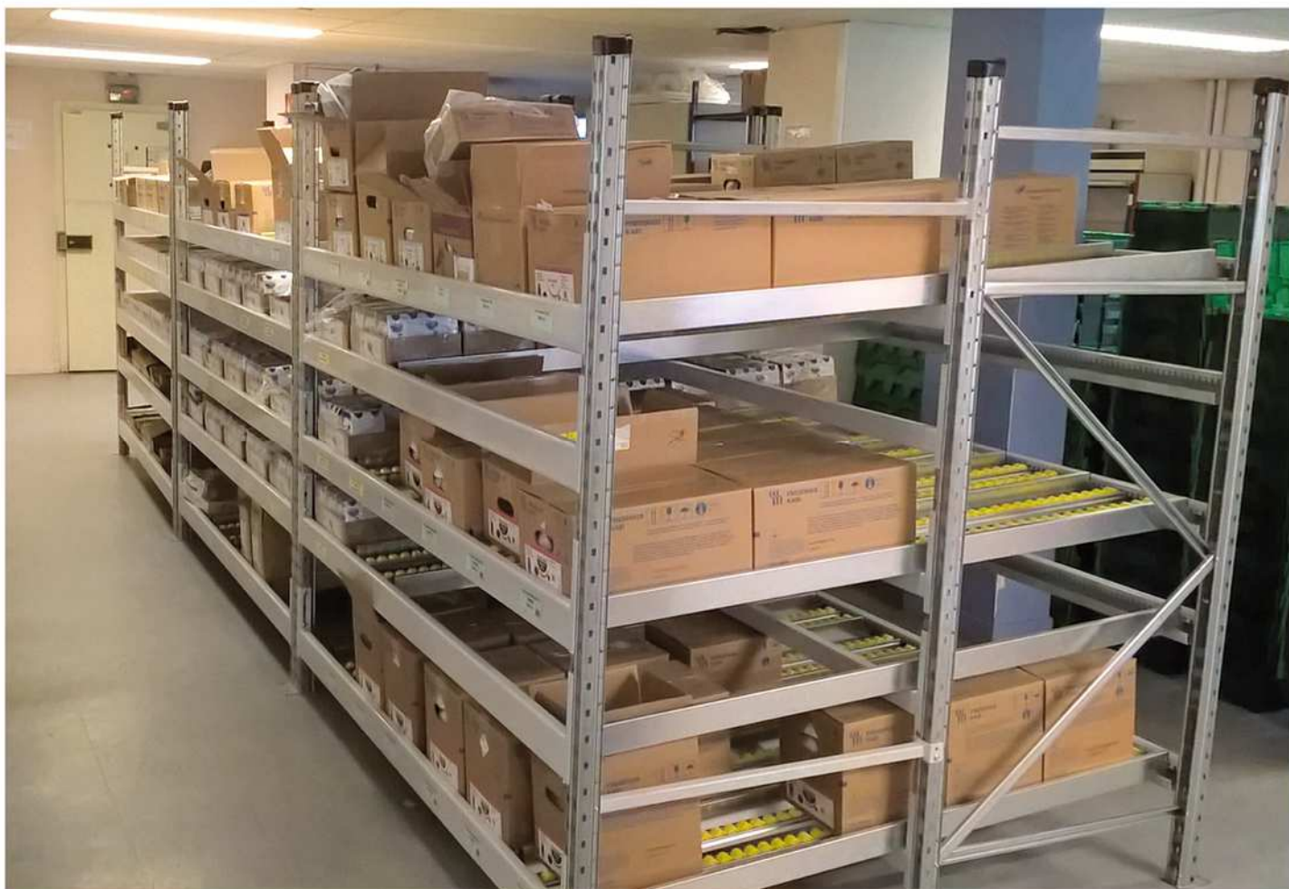
Le stockage dynamique permet de respecter le FIFO des bacs et des cartons.
