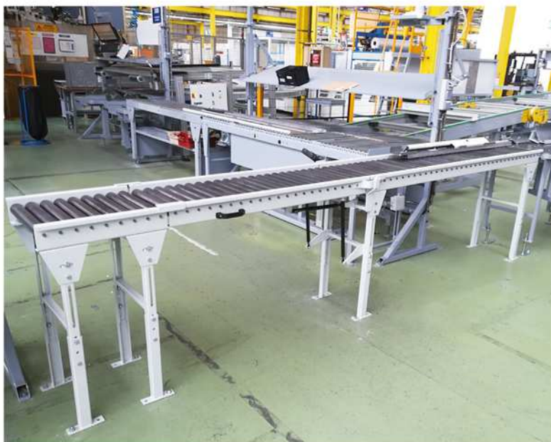
Lignes de convoyeur avec portillon relevable.
