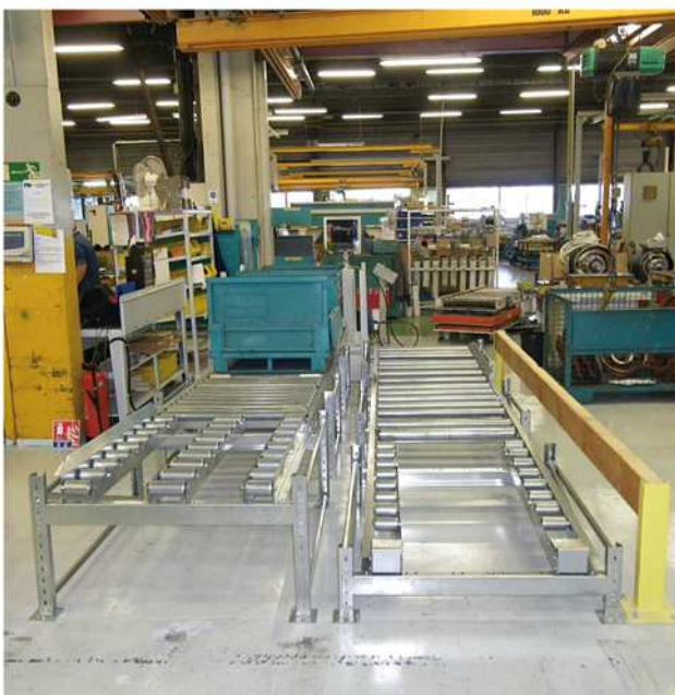
Lignes de dynamique au sol pour accumulation de palettes.
