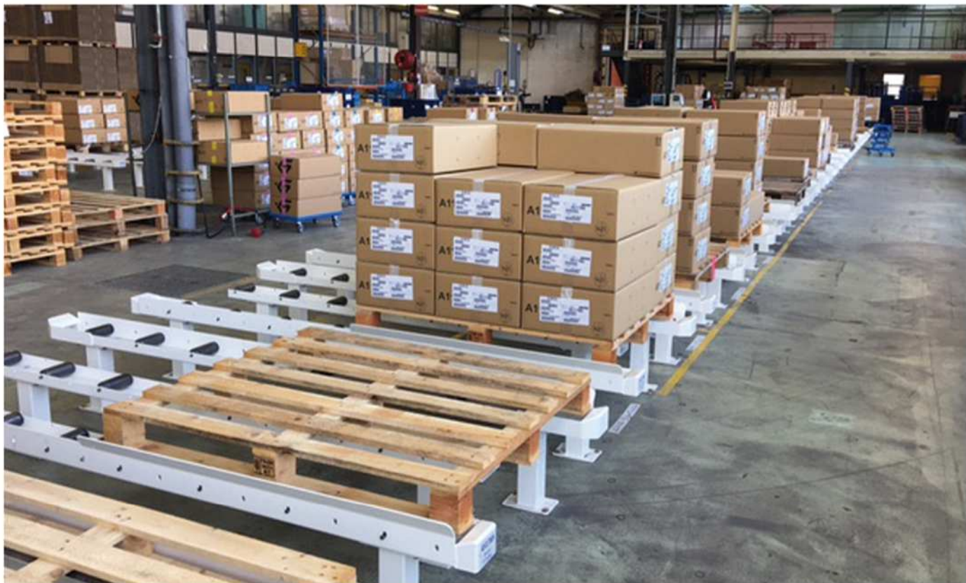
Zone de préparation de commandes sur rails au sol surélevés.
