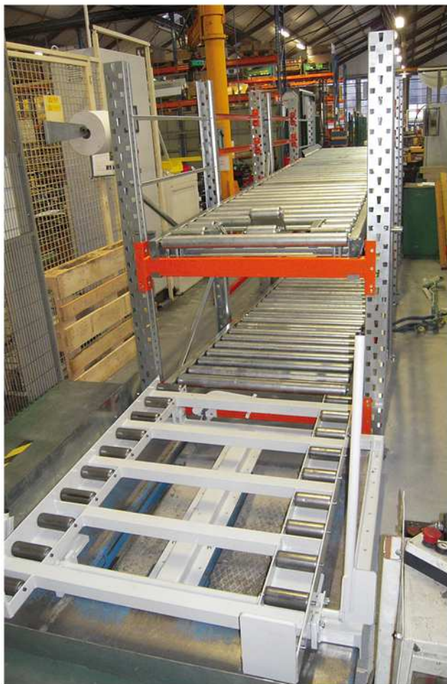
Dynamique palettes aller-retour sur 2 niveaux avec transfert sur table élévatrice.
