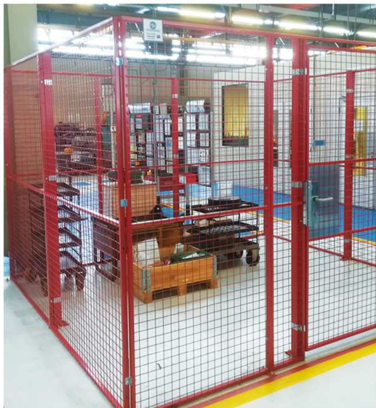
Cloison grillagée pour zone rebut.
