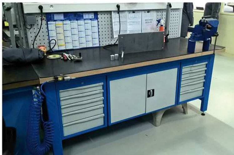
Etabli équipé de coffre-tiroirs et bloc double portes.
