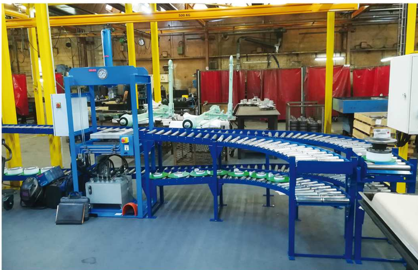
Convoyeur courbe à double niveaux pour poste de montage.
