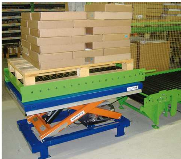
Ligne de convoyeur avec table élévatrice.
