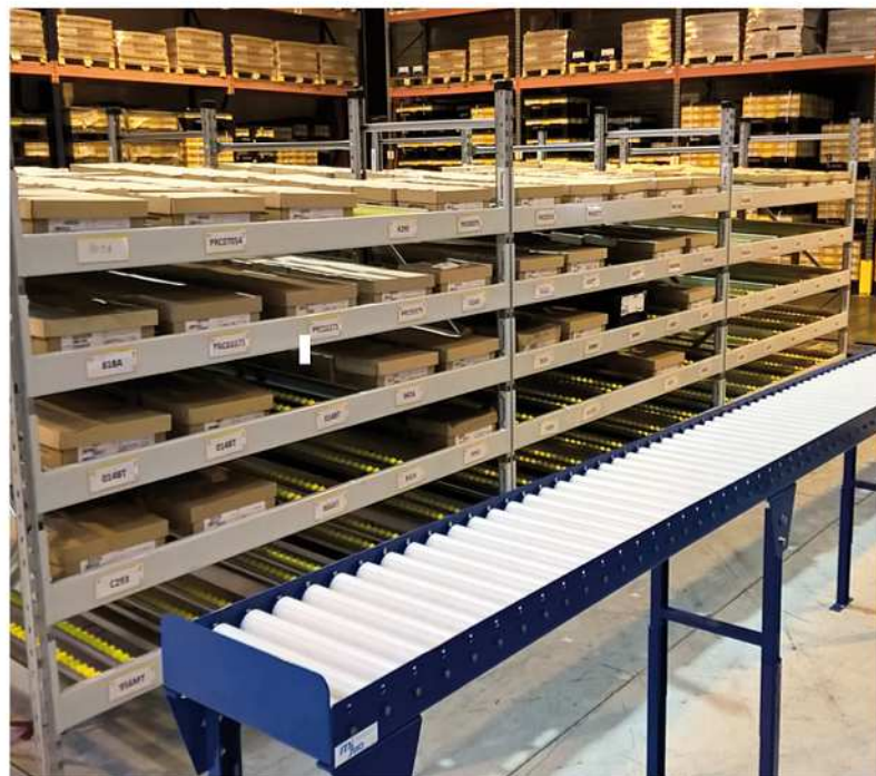
Dynamiques avec convoyeur pour évacuation des commandes.
