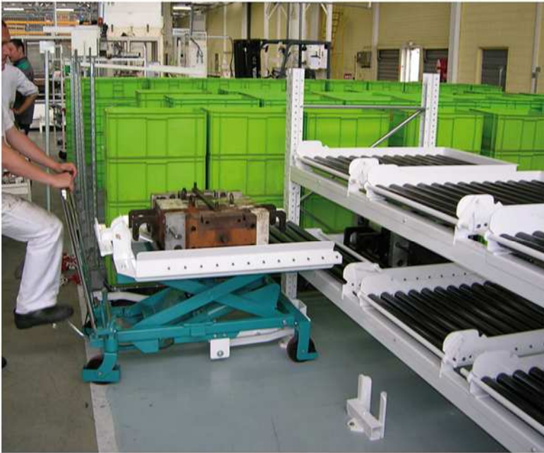
Stockage dynamique avec convoyeurs et table élévatrice.
