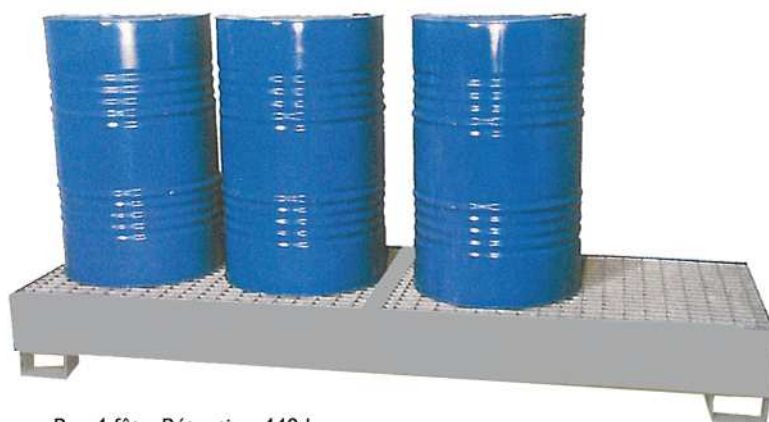
Bac 4 fûts. Rétention 440 l. L.2500 x P.830 x H. 210 mm + pied 100 mm Réf. 60107
