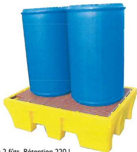
Bac 2 fûts. Rétention 220 l. L.1310 x P. 910 x H. 380 mm Réf. 60003
