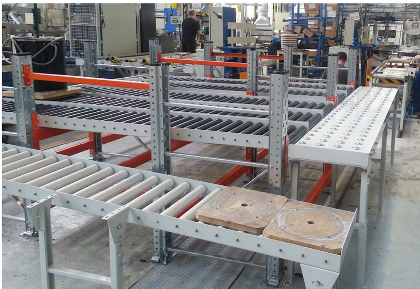
Les éléments modulaires de convoyeurs à rouleaux libres permettent de réaliser des lignes de manutention à la demande.
