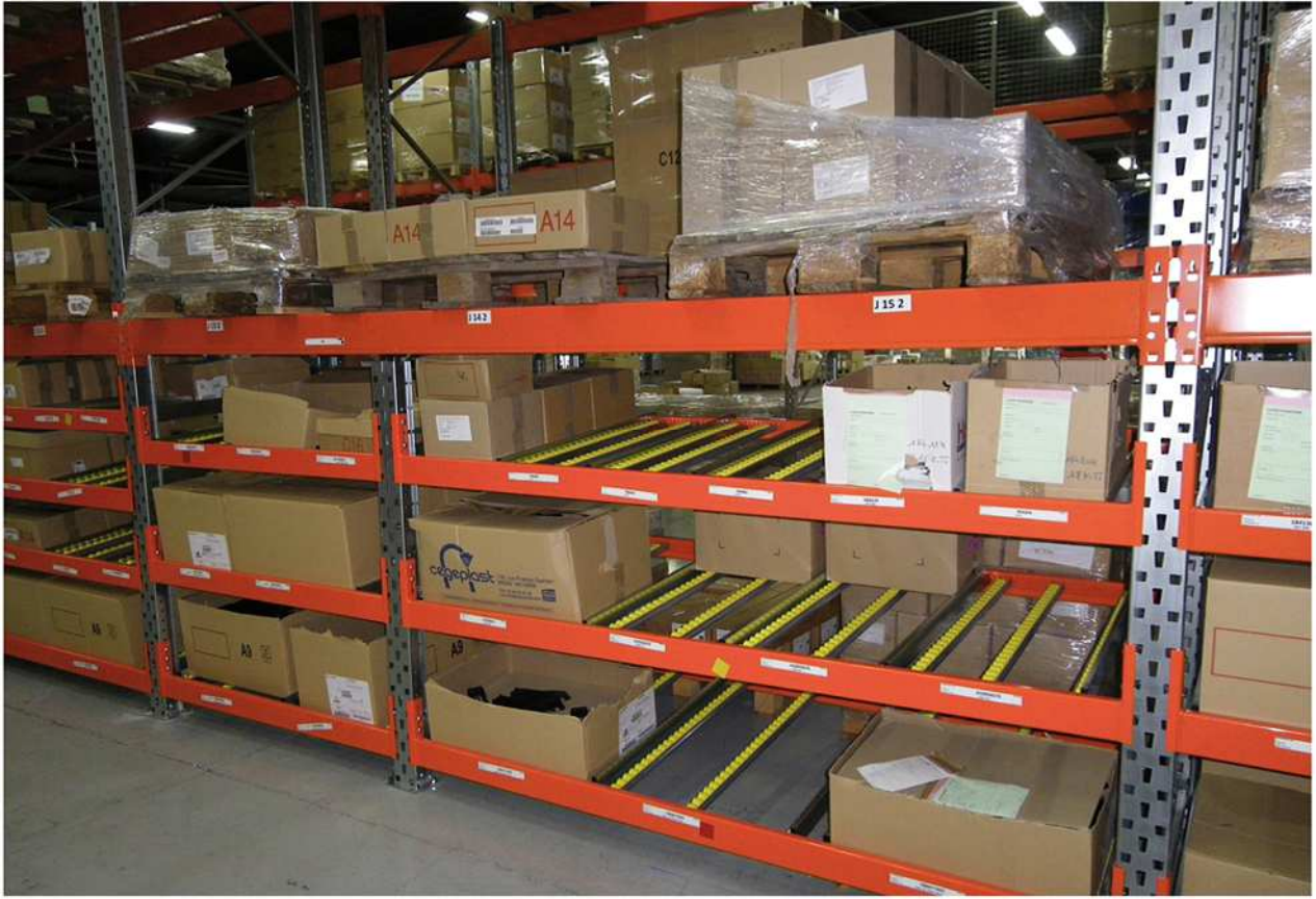
Stockage dynamique dans un rayonnage à palettes.
