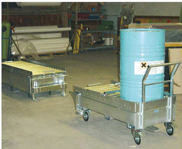
Chariot convoyeur avec bac de rétention.
