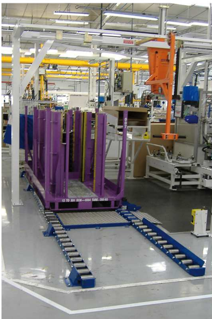
Rails à rouleaux au sol pour conteneurs métalliques.
