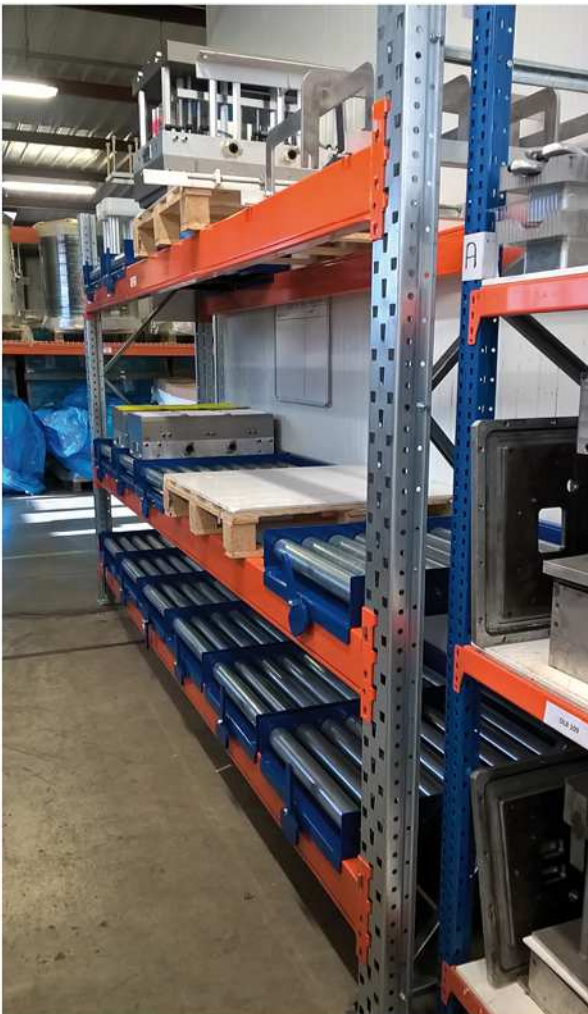
Stockage dynamique dans du rayonnage à palettes.
