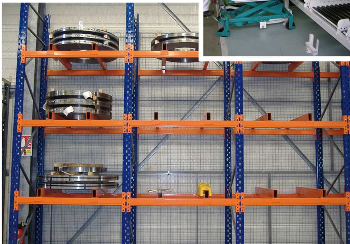
Rayonnage à palettes avec traverses pour stockage de moules.
