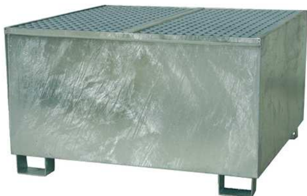
Bac pour 1 cubitainer. Rétention 1000 l. L. 1225 x P. 1275 x H. 650 mm + pied 100 mm Réf. 60151
