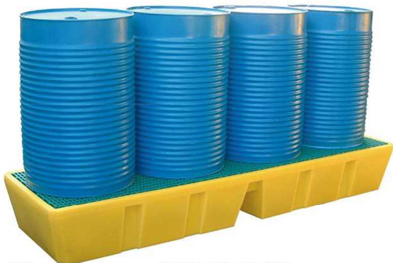
Bac 4 fûts. Rétention 450 l. L.1235 x P. 1235 x H. 475 mm Réf. 60005
