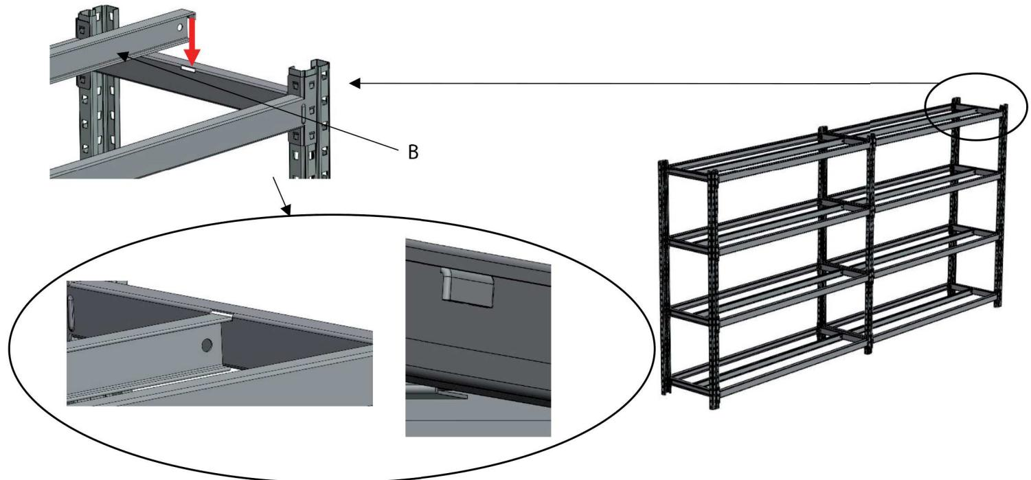
2) Principe de montage : Élément double face
